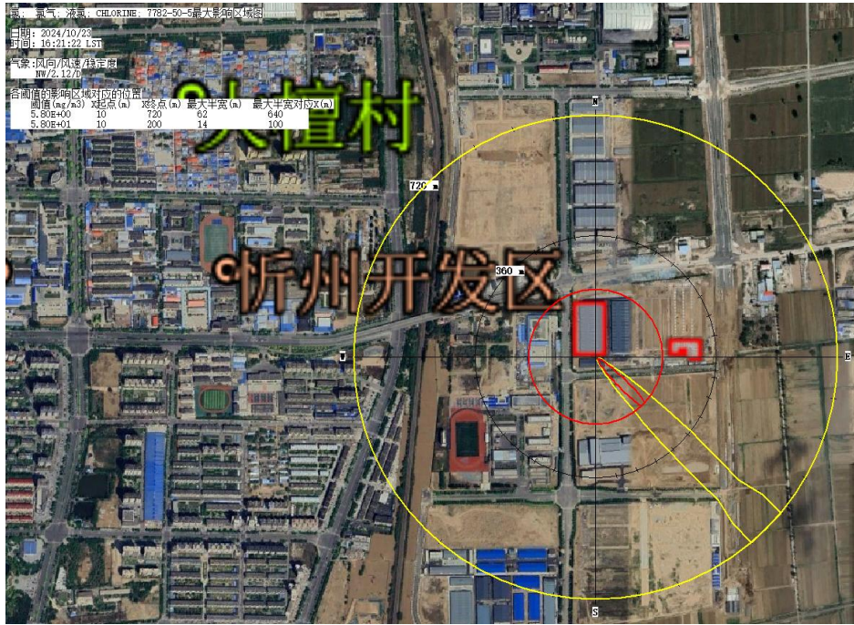
图 5.8-13 氯气最常见气象条件下超过阈值的最大轮廓范围图
